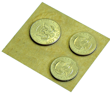
Paper Roll (A型)： 用來固定薄型平滑的零件。
